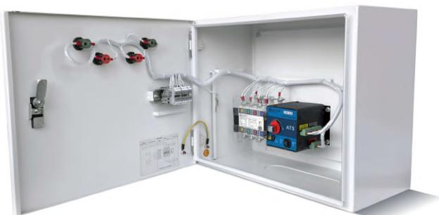
**TABLERO DE TRANSFERENCIA AUTOMÁTICA** (ATS por sus siglas en inglés: Automatic Transfer Switch) es un complemento de nuestros generadores. Se encarga de monitorear la continuidad de la energía de la red eléctrica. Al momento de identificar un corte de suministro, el equipo ATS envía una señal al equipo, indicándole que debe comenzar a funcionar, y a su vez al detectar la vuelta de la red eléctrica, entrega una señal al generador, deteniendo así su funcionamiento.
