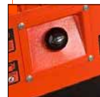
Tanque de Combustible con capacidad de 120L
