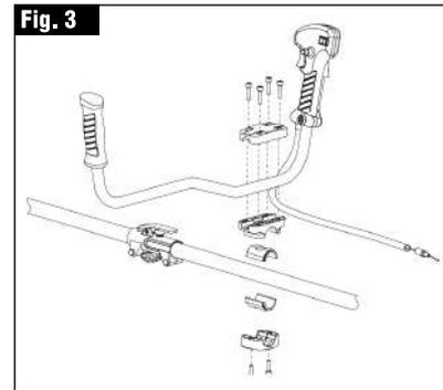
**5.2. CONEXIÓN DEL CABLE DEL ACELERADOR**
