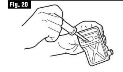
1. Retire el silenciador, inserte un destornillador en la ventilación y limpie cualquier acumulación de carbono. Limpie cualquier acumulación de carbono en la ventilación de escape del silenciador y en el puerto de escape del cilindro al mismo tiempo.
