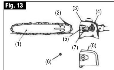
Instale la barra guía y la cadena de la caja de engranajes de la siguiente manera:
