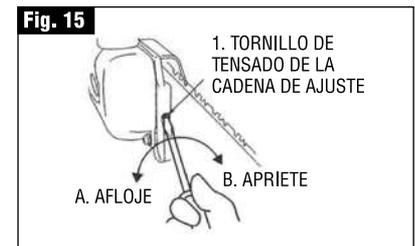
5. Apriete la tuerca de montaje de forma segura con la barra Consejo levantó (PAR: 8.9-1.7 Nm /90-120 kg-cm). A continuación, compruebe la cadena de rotación suave y la tensión correcta mientras se mueve con la mano. Si es necesario, lea los ajustes.
