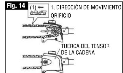
4. Ajuste la tensión de la cadena girando el tornillo tensional hasta que las correas toquen la parte inferior del riel de la barra.
