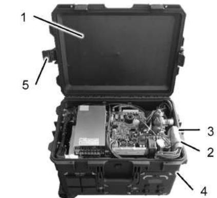
(3). Como se muestra en la figura anterior, coloca el conector de la batería 2 y el conector de la estación de energía 3 en la posición correcta en el alojamiento 4 y organiza todos los conectores expuestos, arneses de cables y otras partes dentro del alojamiento 4 para asegurarte de que no afecten el cierre de la cubierta superior 1.
