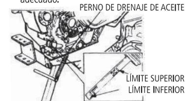
Al momento de revisar y/o rellenar aceite, el motor debe estar en posición horizontal para conseguir una correcta lectura. Cambio: Suelte el perno de drenaje y vacíe el motor del aceite usado. El aceite escurrirá mejor si el motor está aún caliente. Tenga cuidado en evitar quemaduras. Rellene con el aceite adecuado. Para más detalles refiérase al manual de uso de la unidad motriz.
