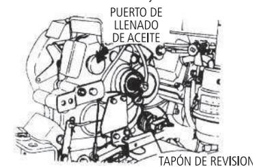
**Cambio:** Quite el tapón de drenaje en la parte inferior de la caja. Drene el aceite usado, coloque el tapón de nuevo, pero sin apretar y añada aceite de caja nuevo a través del puerto de llenado. La cantidad de aceite queda determinada una vez que empiece a salir aceite por el tapón de drenaje, que a esta altura se encuentra suelto.
