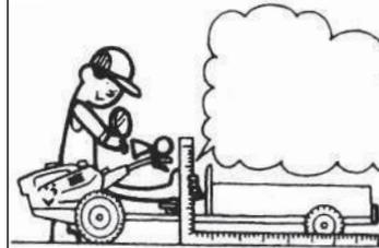
La velocidad de trabajo de la máquina debe ser menor a 15km/h. Este límite no debe romperse bajo ninguna circunstancia. La carga en el remolque está limitada a 500 kg. No debe superarse este límite.
