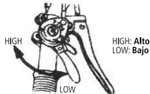
Esta palanca es usada cuando es necesario ajustar la velocidad del motor. El acelerador debe colocarse en posición "HIGH" al momento de arrancar el motor y dejarlo en posición "LOW" antes de apagarlo. Puede ser dejado en cualquier posición mientras el equipo esté funcionando.
