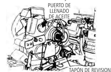
**Cambio:** Quite el tapón de drenaje en la parte inferior de la caja. Drene el aceite usado, coloque el tapón de nuevo, pero sin apretar y añada aceite de caja nuevo a través del puerto de llenado. La cantidad de aceite queda determinada una vez que empiece a salir aceite por el tapón de drenaje, que a esta altura se encuentra suelto.
