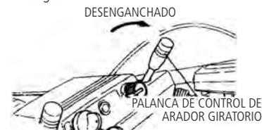
**Método de ajuste:** Ajuste con el ajustador de piola hasta que se pueda realizar un enganche y desenganche seguro del arador giratorio.
