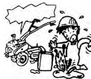
En invierno, cuando la máquina sea encendida en interiores debe preocuparse que exista suficiente ventilación, los gases de escape contienen monóxido de carbono (CO) un gas altamente venenoso para la salud.
