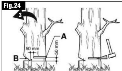
**Fig.24** (A) CORTE PRINCIPAL (B) MARCA (HASTA 1/3 DEL DIÁMETRO DEL ÁRBOL) (3) DIRECCIÓN DE CAÍDA. DERRAMAR Y TROZAR.
