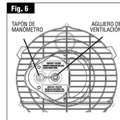
Retire la tapa del manómetro. Conecte un manómetro en el puerto de medición de presión de la bomba. Encienda el Turbocalefactor y lea el valor de la presión de aire. Si es necesario, ajuste la presión al valor correcto girando el tornillo de ajuste en el sentido de las manecillas del reloj para aumentar y en sentido contrario para disminuir la presión:
