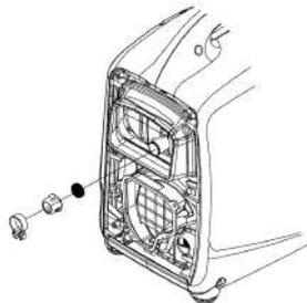
8.4.3. Use un cepillo para eliminar los depósitos de carbón del supresor de chispas. Si el supresor de chispas está desgastado, reemplácelo.
