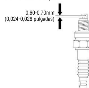
**8.3.6.** Mida el espacio de la bujía con un calibre. El valor normal: 0,6-0,7mm (0,024-0,028 pulgadas). Ajuste el espacio doblando uno de los electrodos con cuidado.
