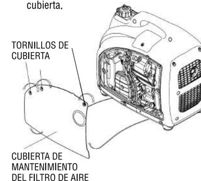
**B.** Afloje el tornillo de la cubierta del filtro de aire y retire la cubierta
