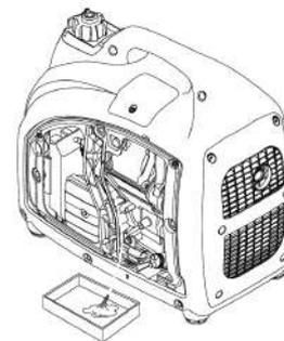
c) Quite la tapa de la bujía, tire de la palanca de arranque tres o cuatro veces, descargue la gasolina de las líneas de combustible.
