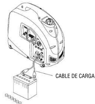
**NOTA:** No arranque el motor del automóvil cuando el generador aún esté conectado a la batería, de lo contrario, el generador se dañará.
