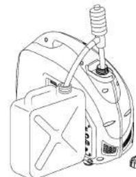
b) Gire el interruptor del motor a la posición "ON" (encendido), y afloje el tornillo de drenaje del carburador para descargar la gasolina dentro del carburador.
