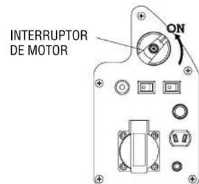
**5.3. Gire el interruptor del motor a la posición "ON" (ENCENDIDO).**
