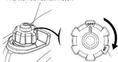
**!** **NOTA:** Al transportar el generador, gire la palanca de ventilación de la tapa del combustible a la posición "OFF" (APAGADO).
