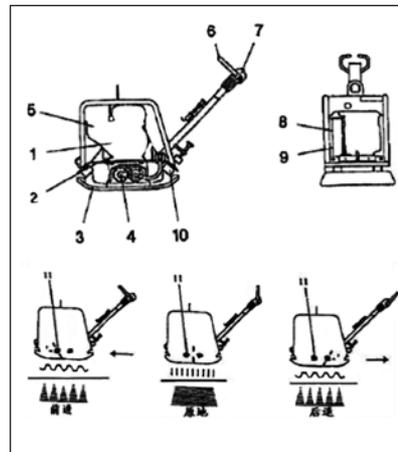
El sistema de vibración se compone de la placa inferior (3) y el eje excéntrico fijo (4) el que fue diseñado para vibrar en una sola dirección, la dirección de avance se puede cambiar modificando la sincronización del excéntrico móvil (11) y se hace fácilmente operando el mando superior (6) en la manilla principal (7). Llevar el mando hacia adelante hará que la máquina avance y viceversa.
