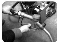
2. Aplicar potencia al motor conectando el cable de alimentación a una fuente de alimentación. Encienda la bomba con el interruptor de encendido/apagado.
