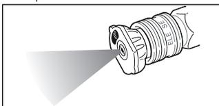
**Boquilla química - NEGRA.** Esta boquilla es usada para aplicar químicos o soluciones de limpieza. Tiene el menor poder de descarga.
